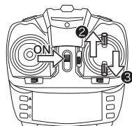
④送信機の電源を入れスロットルスティックをフルハイ(100%)位置に上げ(図②)、すぐに0(ゼロ)位置(図③)に戻します。機体のLEDが点滅から点灯に変わり、操作できる状態になります。
