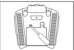
カバーを閉じ、ネジを締めて\*固定します。
