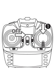
①送信機の電源がオフになっている事を確認し、スロットルレバーを最スロー(図①)まで下げます。
