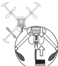
②機体にLiPoバッテリーを接続し、バッテリーをバッテリーホルダーに収納します。
