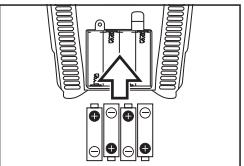
単三乾電池を4本、図のように正しい向きにセットします。
