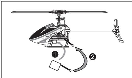
2. 機体に①LiPoバッテリーをスキッドに差し込み、しっかり装着されていることを確認してから、②LiPoバッテリーと機体側コネクタを極性に注意して接続します。機体をすぐに水平な場所に置いてください。しばらくすると操作が可能な状態になります。
