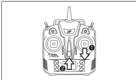
1. 送信機の電源が切れている状態で、①スロットルスティックを最スロー位置にしてから、②送信機電源をONにします。
