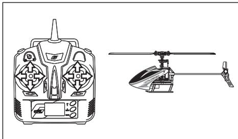
3. 機体が操作可能になったら、いきなりフライトせず必ず送信機の各スティックが正しく動作するかを確認してください。また、機体各部に異常がないか確認し、異常があるときは修理・パーツ交換してください。
