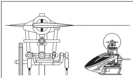
4. スロットルホールドスイッチをONにし、スロットルスティックを中立(50%)にしたときに、メインローターブレード角度が0°となることを確認します。工場出荷時には初期設定されています。
